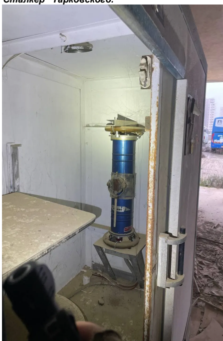
▲ В синем корпусе - вакуумная трубка, на неё подают напряжение и ионизирующие лучики из круглого окошка начинают радовать окружающих. Когда обесточена - радиации нет.
